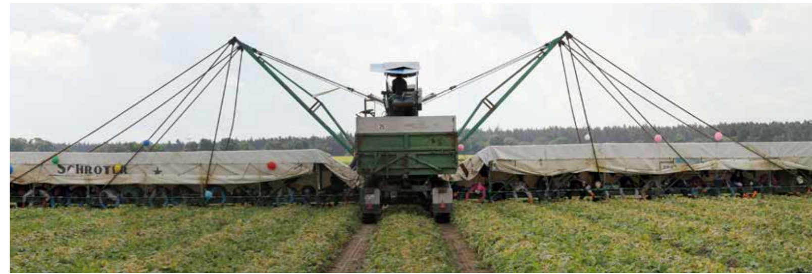
Gurkenflieger werden die landwirtschaftlichen Fahrzeuge genannt, auf denen bis zu 50 Erntehelfer im Einsatz sind (© ATB).
