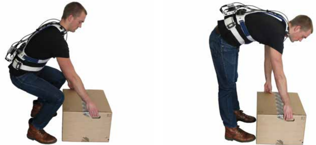
Ergonomische und unergonomische Hebebewegung mit der CareJack-Softrobotikorthese bei der Warenkommissionierung (© Fraunhofer IPK)
