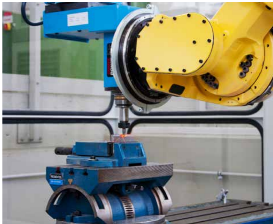
Hochgeschwindigkeitszerspanung von Inconel 718 mit einem Fanuc M-900iB/700
